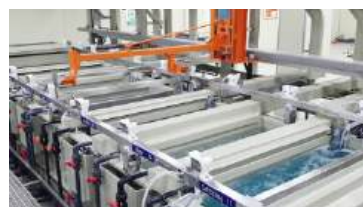
Dây chuyền mạ kẽm cho vật liệu thép - Kiểu nhúng
