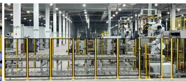
Dây chuyền hàn vỏ pin công suất 100.000 sản phẩm/ năm cho nhà máy sản xuất ô tô
