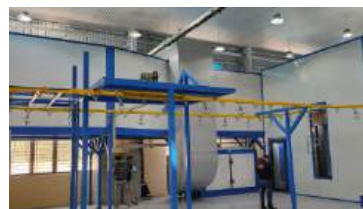
Dây chuyền sơn tĩnh điện bán tự động - Sử dụng nhân viên sơn
