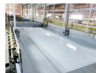
Dây chuyền sơn điện ly CED Kiểu nhúng
