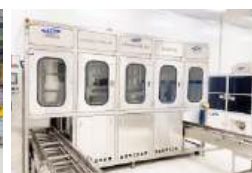
Hệ thống máy rửa tự động (thay hệ thống sơn phủ sử dụng robot)
