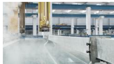
Dây chuyền Anod cho vật liệu nhôm - Kiểu nhúng
